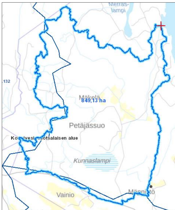
Kuva 4. Vesistöön johtavan ojan valuma-alue Metsäkeskuksen valuma-alueen määrittelytyökalun mukaan. 6/2025.
