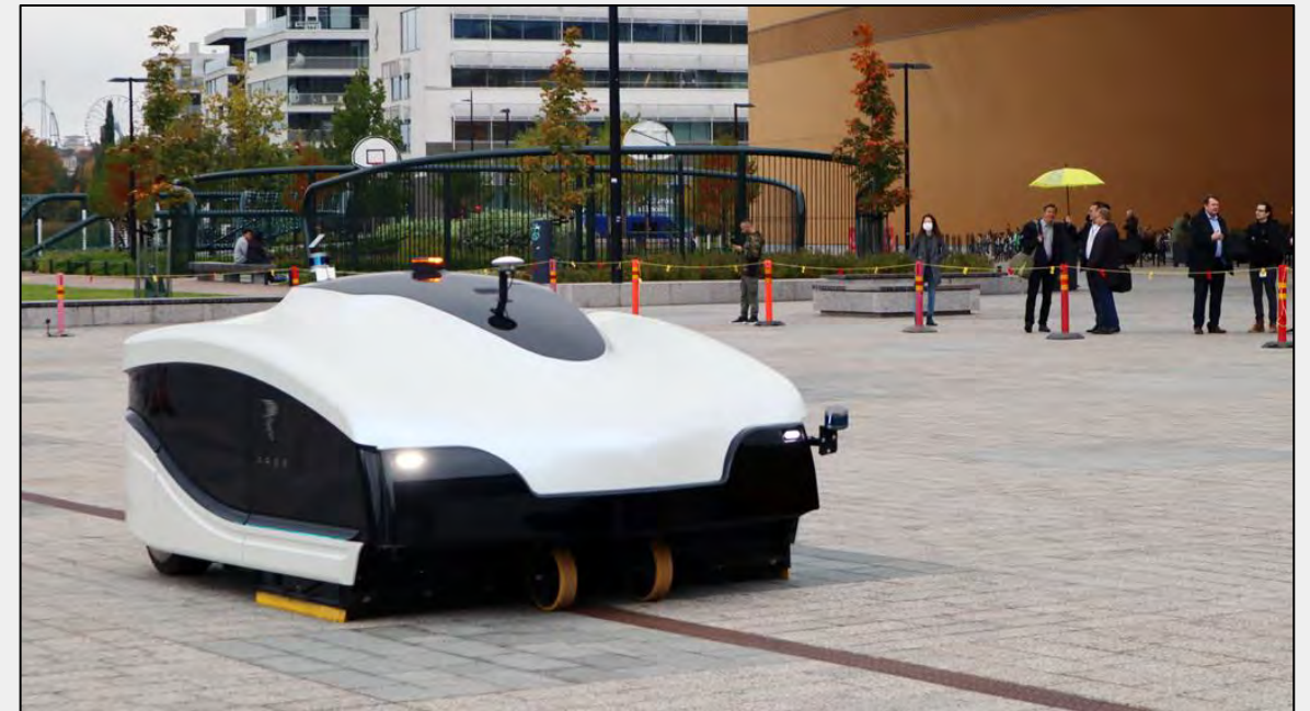
Kuva 10. Trombia Free robottilakaisukone (kuva: Konepörssi.com)
